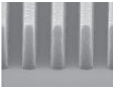
300 nm lines and spaces mit dem AZ® 701 MiR
