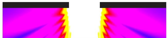
Querschnitt der Intensitätsverteilung von i-line (365 nm) Licht in einer 2 µm dicken Lackschicht unter einem 2 µm breiten Spalt ohne (oben) und mit (unten) einem 10 µm proximity gap.
